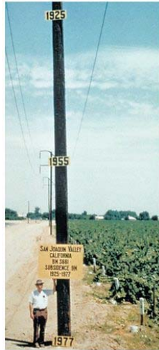
Figure 29: Illustration des effets du phénomène de subsidence, dans la San Joaquin Valley : entre 1925 et 1977, le sol, par endroits, s'est affaissé de façon dramatique.
