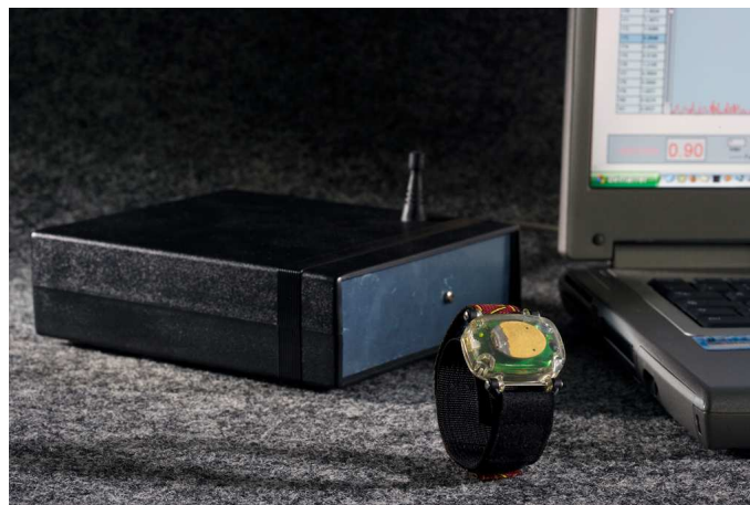
FIG. 2.5 – Le système Starwatch : capteur sans-fil, base radio, et PC
