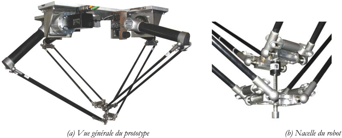
Figure 2.14 Photos du démonstrateur du Héli4
