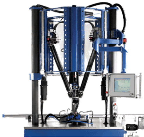
Figure 1.21 Manipulateur utilisant l'architecture Delta avec actionneurs linéaires
