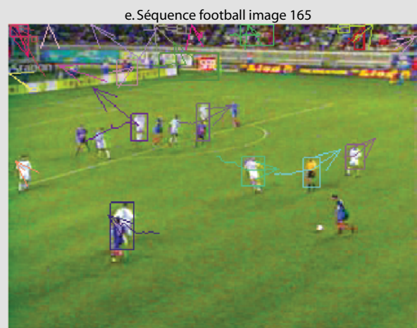
Figure IV.8: test du système de suivi temporel d'objets en mouvement. a-b-c, test en caméra fixe dans une séquence test PETS 2001 (test set 2, caméra 2) (Résolution de l'image: 576*768 pixels). d-e, Test en caméra mobile sur une séquence vidéo compressée de football (résolution image: 320*240)
