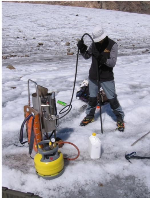
(d) Implantation d'une balise en zone d'ablation avec une sonde à vapeur en automne.
