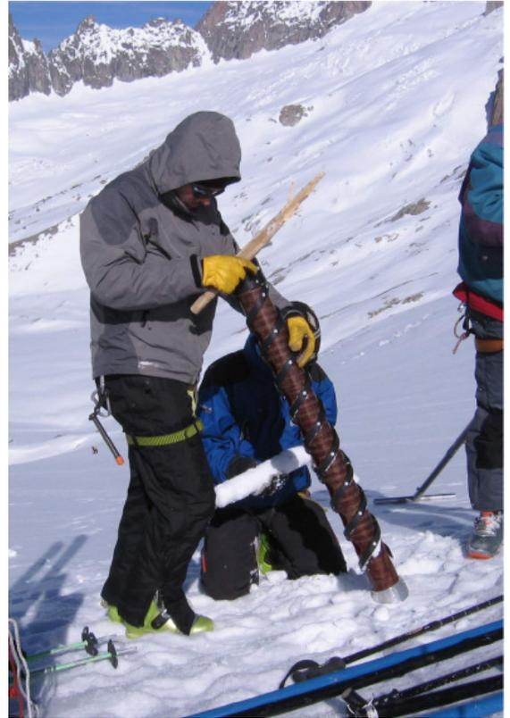
(c) Carottage de surface au printemps en zone d'accumulation.
