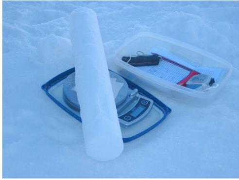
(a) Mesure de densité. Density measurement.
