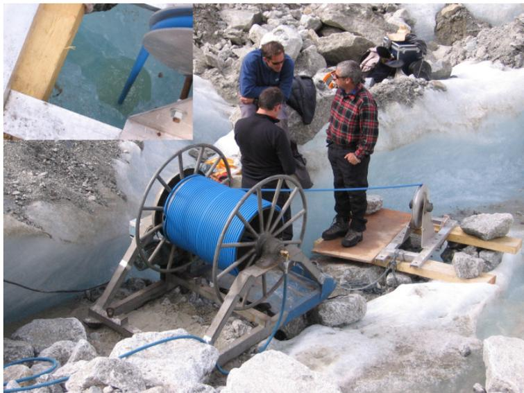
FIG. 4.4.: Mesures de l'épaisseur de glace à l'aide de forages.
