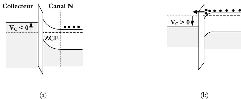
Fig.22. Structure de bandes d'énergie de la collecte des électrons du canal N pour différentes polarisations du collecteur ( $V_C$ ). (a) à  $V_C < 0V$ , ce régime correspond à la désertion des électrons du semiconducteur, (b) à  $V_C > 0V$ , ce qui correspond à la collecte des électrons.
