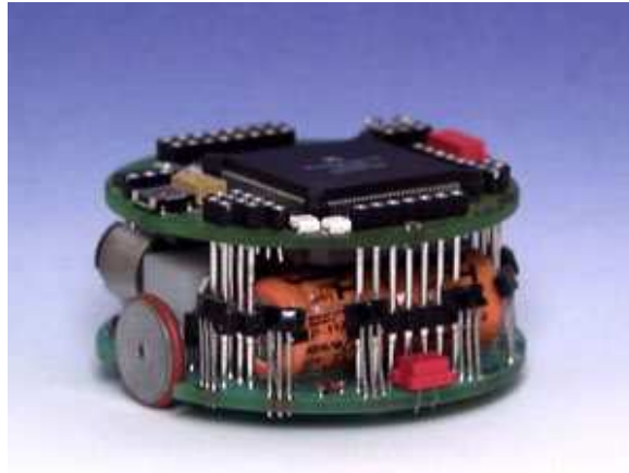
FIG. 6.5 – Le robot Khepera
