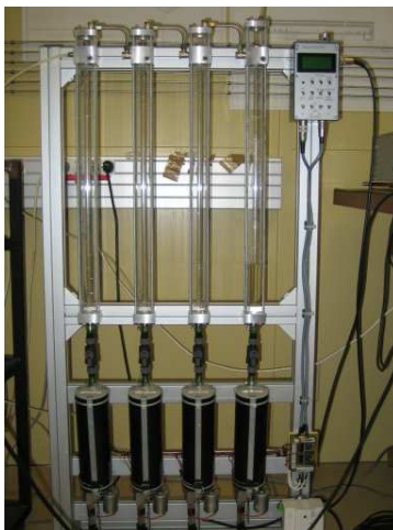
FIG. 2.10 – Régulateur de pression fabriqué au laboratoire et utilisé pour les différents tests présentés dans cette étude.
