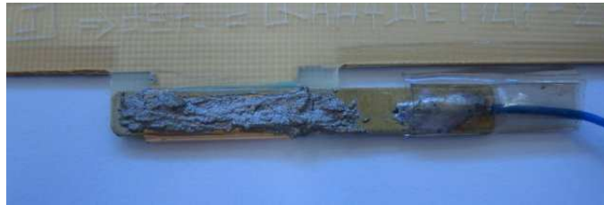
FIG. 2.5 – Photographie de l’arrivée de haute tension sur une micro-grille.
