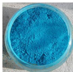
Les  $H_2Pc$  ont l'aspect d'une poudre de couleur bleue (figure ci-contre). Nous avons utilisé des  $H_2Pc$  pures à 99% fournies par Aldrich.
