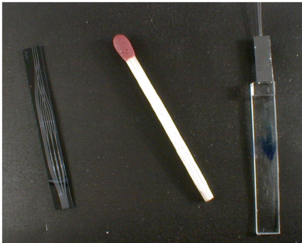
FIG. 2.5 – Composants d’optique intégrée à trois télescopes suivant la technique de gravure de silice sur silicium (LETI, gauche) et suivant la technique d’échange d’ions sur verre (IMEP, droite).
