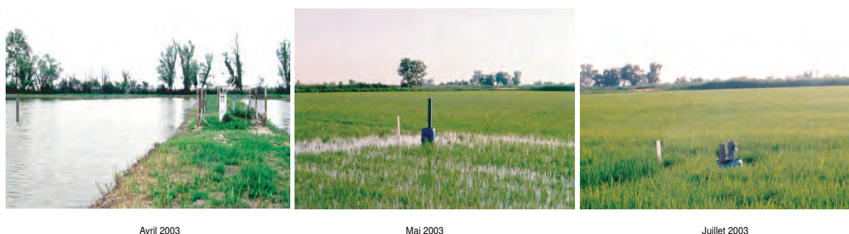
FIG. 3.1 – Dispositif de mesure installé en profondeur dans la nappe de la rizière durant la période irriguée.
