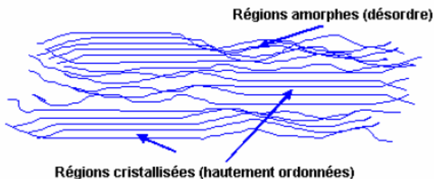
Figure 2.14. Structure d'une microfibrille de cellulose
