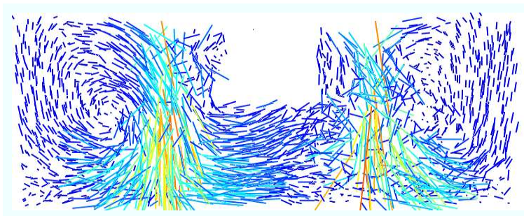
Figure 2.8: Représentation des vitesses des particules dans une tranche du système. Les bourroirs, le blochet et les grains ne sont pas représentés. Les couleurs vont du foncé (bleu) au clair (orange) proportionnellement à la vitesse variant de 0,01 m/s à 1,2 m/s, respectivement.
