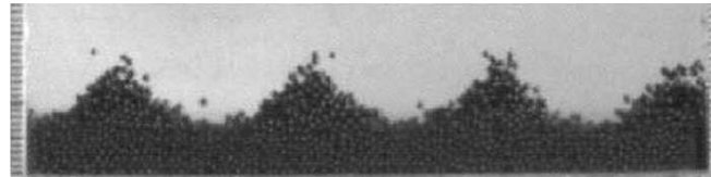
Figure 1.44: Les vibrations sont appliquées verticalement au milieu granulaire. Des vagues apparaissent et sont comparables aux vagues que formerait un liquide [108].
