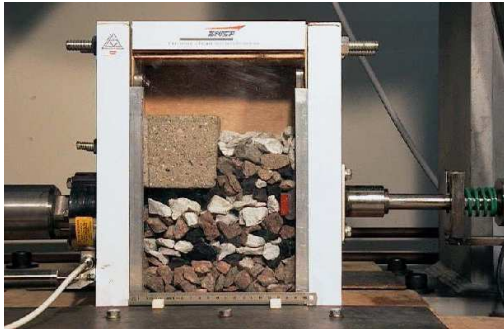
Figure 1.25: Banc d'essai bouba (BOUrage du BALLast). Les vibrations sont appliquées sur une boîte délimitée par une paroi en plexiglas. Une plaque bourroir se déplace horizontalement avec une amplitude contrôlée [86].
