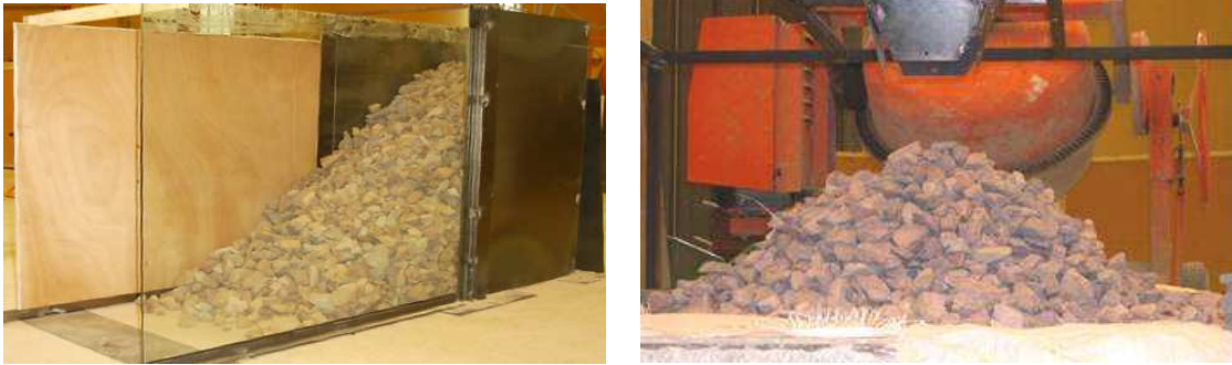
Figure 3.29: Mise en évidence de l'angle de repos du matériau ballast. A gauche les grains sont déposés dans une boîte et s'écoulent suite au relevage d'une des parois ; à droite, les grains tombent d'une hauteur donnée [13, 117].
