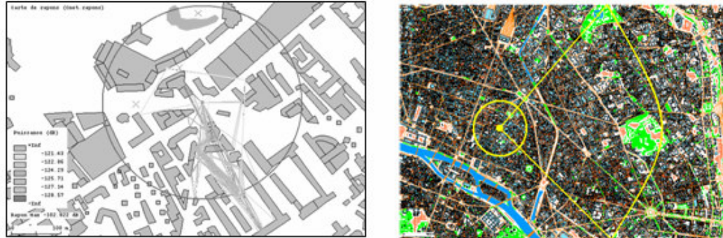
Figure 64 : Tracé des rayons dans une petite zone de 500x700 m 2 (à gauche), Cartographie avec le logiciel GRIMM sur une zone 5 km 2 (à droite)
