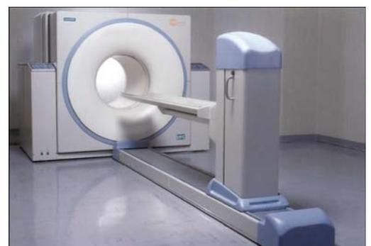
Le TEP ne disposant pas de septa, fonctionne en mode d'acquisition 3D. Il dispose de 288 blocs détecteurs (ci-dessous) répartis sur 4 anneaux couvrant un champ de vue axial de 15,4cm. Chaque bloc étant subdivisé en 8x8 cristaux, cela équivaut donc à 32 couronnes
