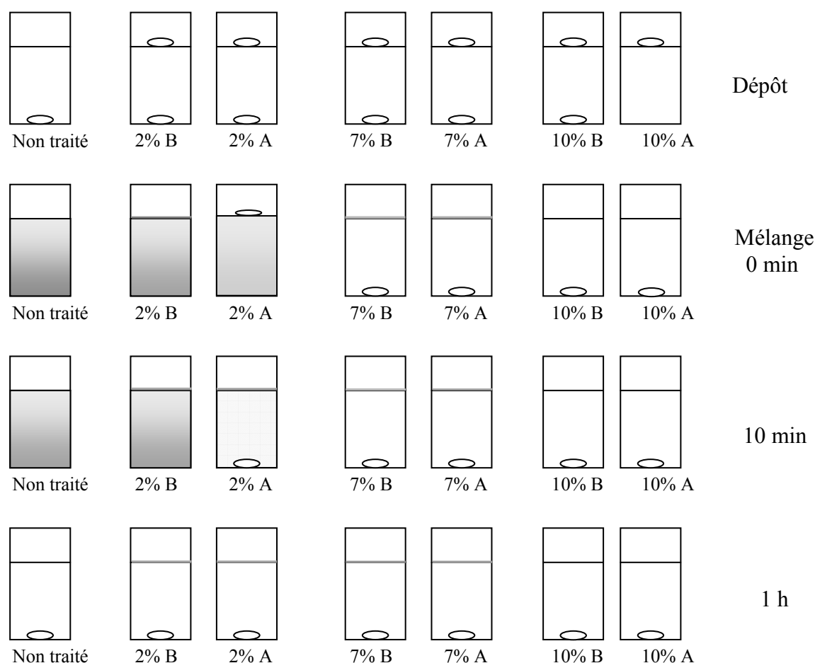
Figure IV.3 – Étude de la sédimentation dans l'eau de l'alumine traitée à divers pourcentages de polymères A et B, initialement déposés sur l'eau et après agitation mécanique.
