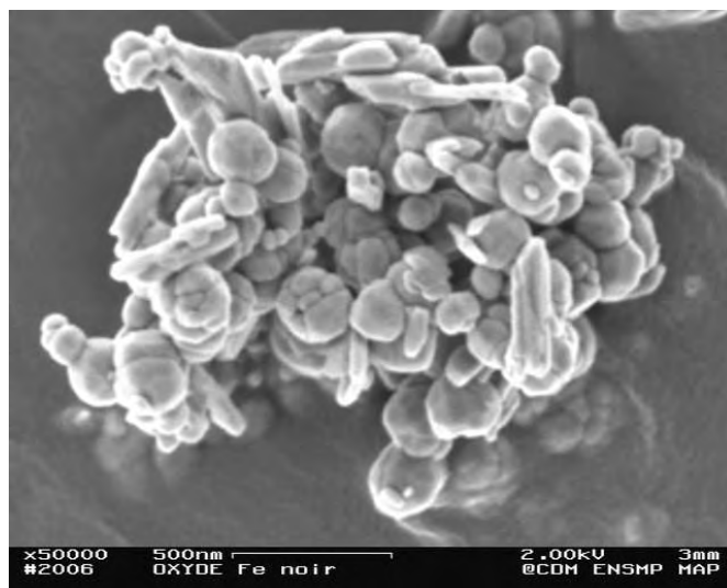
Figure II.9 – MEB. Oxyde de fer noir. Image haute résolution des particules d'oxyde de fer.
