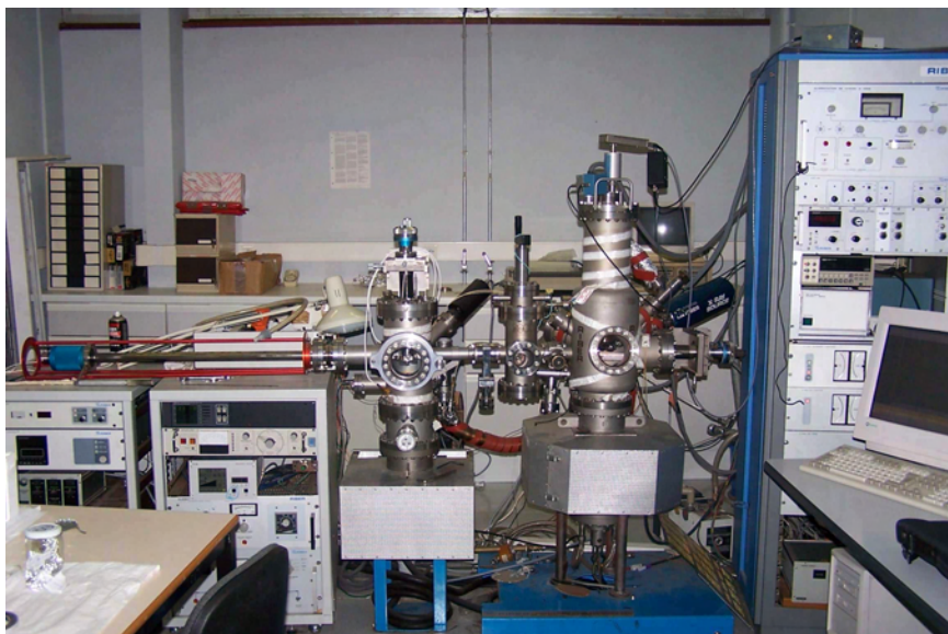
Figure 11 : Photo de l'XPS RIBER MAC2 présent au CEMEF (ENSMP).
