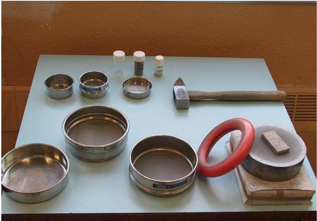
Figure A.2. Photographie qui montre les tubes contenant à gauche les grains tamisés et à droite la poudre fine réalisée à partir des grains, les tamis, le marteau ainsi que la plaquette d'échantillon.
