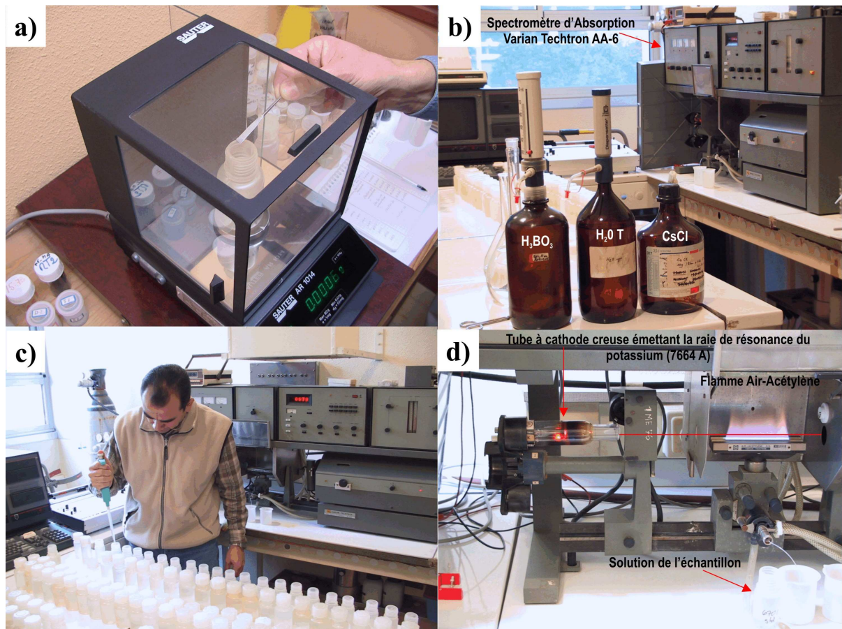
Figure A.3. Dosage du K et des analyses en spectrométrie d'absorption. a) pesée des échantillons ; b) spectromètre d'absorption, acides et solutions pour l'attaque chimique ; c) attaque chimique des échantillons ; d) fonctionnement du spectromètre d'absorption. Photo H. Bellon.
