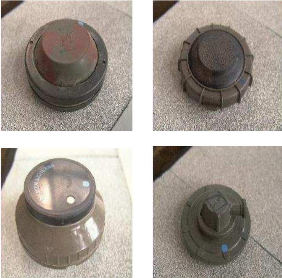
FIG. B.2: Photographies des mines antipersonnel Tecnovar-MAUS1 (en haut à gauche), Valsella VSMK2 (en haut à droite), Tecnovar AUPS (en bas à gauche) et Tecnovar VAR40 (en bas à droite). Les photographies sont issues de [Dea01b].
