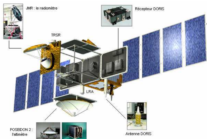
Figure A.8 – Positionnement des instruments à bords de Jason-1.
