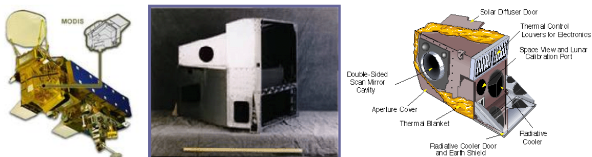
Figure 1.15 – A gauche, emplacement du capteur MODIS sur le satellite Aqua. Au milieu, photographie du capteur MODIS. A droite, schéma explicatif. [ http://modis.gsfc.nasa.org ]
