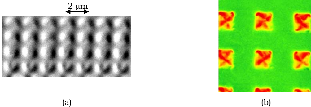
Figure 2.23 : (a) : Image MO en mode Kerr longitudinal de domaines planaires dans une série de motifs carrés de dimension 1\mu\text{m} \times 1\mu\text{m} présent en surface de la couche mince La_{0,7}Sr_{0,3}MnO_3 d'épaisseur 100 nm déposée sur un substrat SrTiO_3 . L'image a été obtenue par soustraction entre une image correspondant à l'état saturé ( H = 50 \text{ Oe} ) et une image correspondant à la zone de transition du cycle d'hystérésis ( H = -3,6 \text{ Oe} ). Les régions d'images de couleur noire correspondent à des domaines magnétiques antiparallèles avec ceux de couleur blanche. (b) Image de parois de domaines ayant une composante hors du plan effectuée par la technique MFM.
