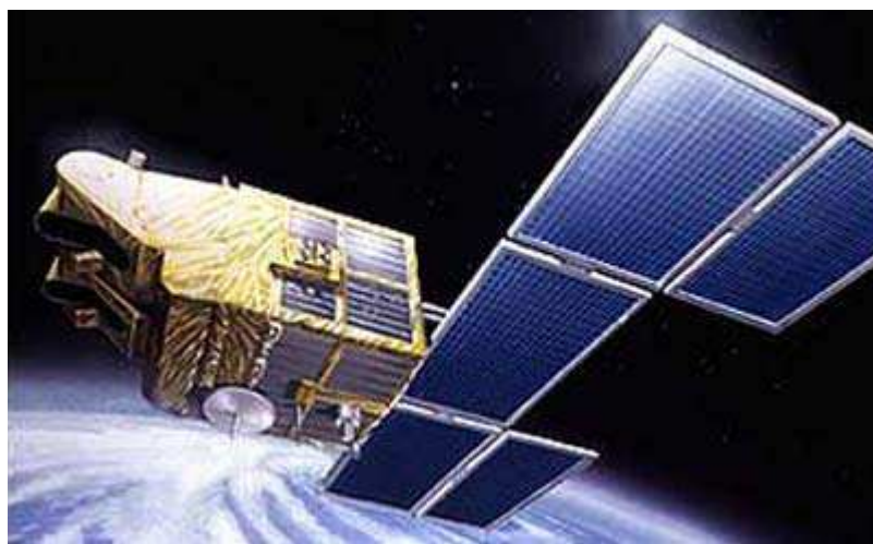
Figure 2-2 : Le capteur Spot 5
