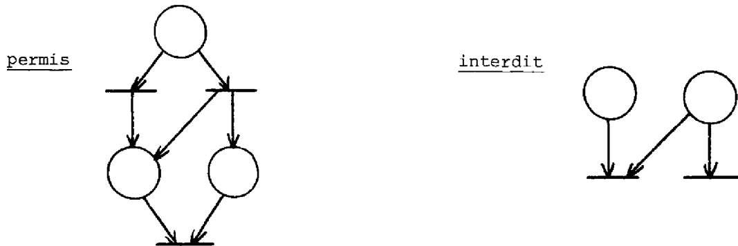
FIGURE I.23. Configurations permises et interdites dans un réseau de PETRI libre choix.
