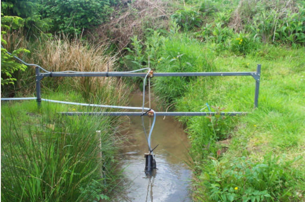
Fig. 2 - Fixation d'un turbidimètre à l'exutoire d'un bassin versant (exemple à l'exutoire des Violettes, Manche (50)).
