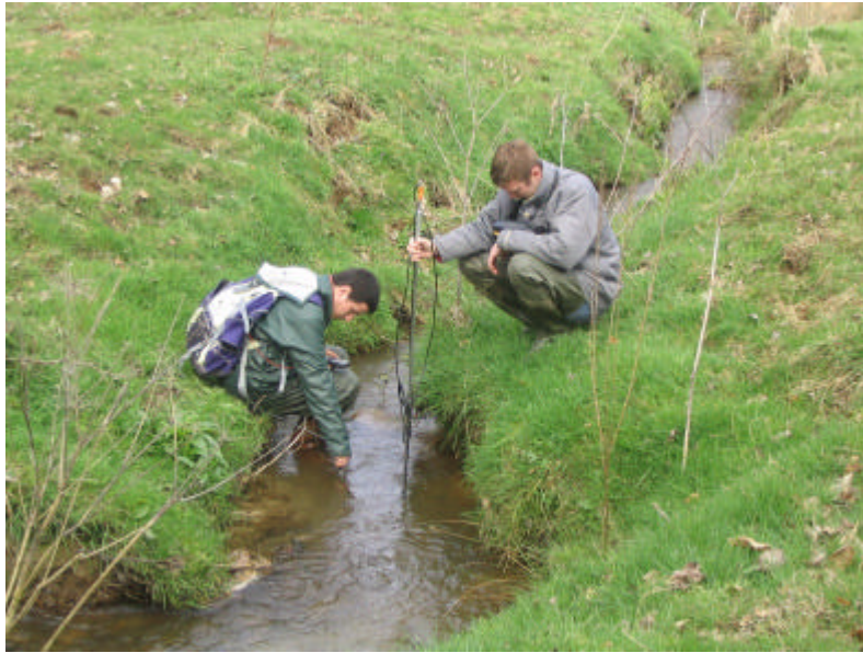
Fig. 21 - Mesures itinérantes de turbidité et de débit.
