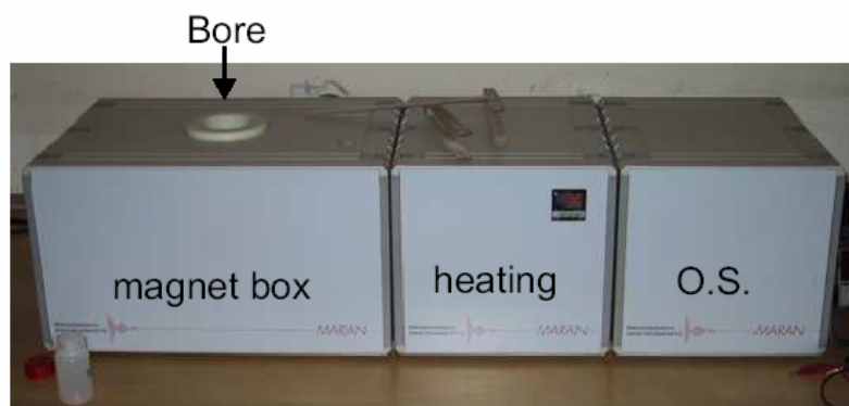
Figure 1-18. Spectromètre RMN Maran Ultra 2 MHz
