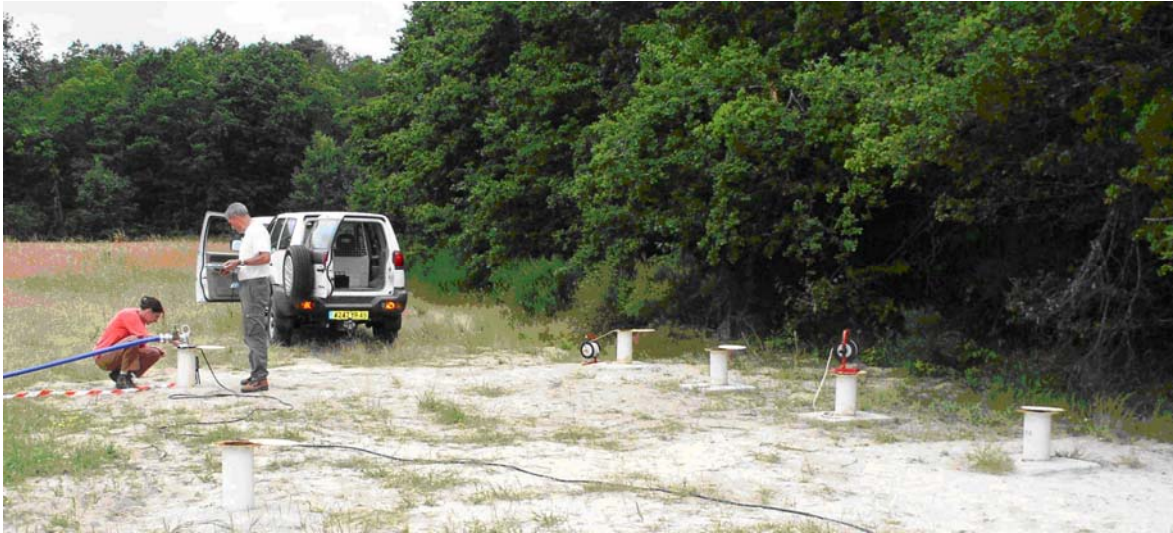
Figure 1-10. Mise en œuvre d'un essai de pompage (Photo prise sur le site de Marcilly-en-Villette en juin 2006)
