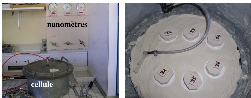
Figure 2-26. Echantillons de craie dans une cellule de Richards
