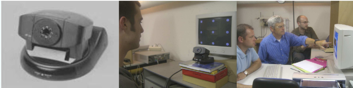
FIG. 4.27 – En partie gauche de la figure, la caméra utilisée ; au centre, le sujet positionné face à l'écran diffusant les images et à la caméra filmant l'un de ses yeux ; à droite, les expérimentateurs devant leurs écrans de contrôle pour la diffusion des images et l'enregistrement des mouvements oculaires du sujet.
