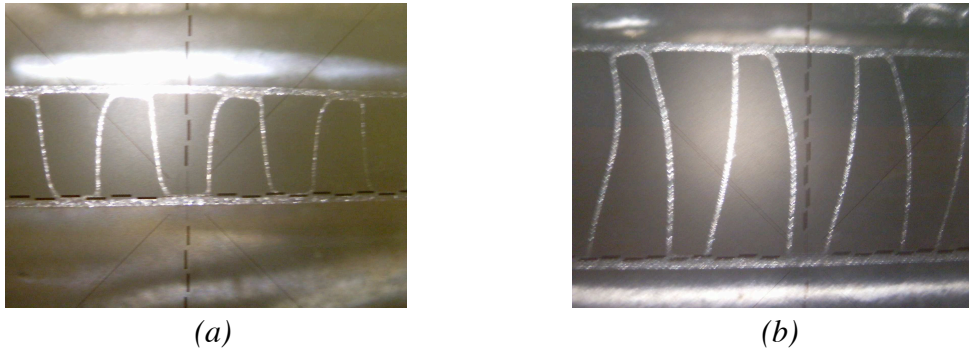
Figure VI-2 – Forme réelle initiale d'intercalaire (a) chaud (b) froid
