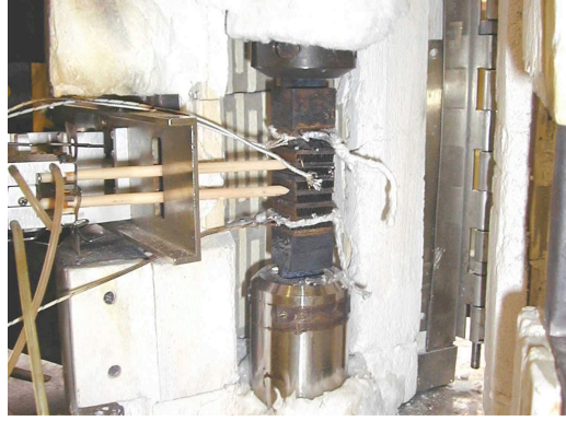
Figure III-5 – Extensomètre monté sur une éprouvette de traction à chaud selon (y)
