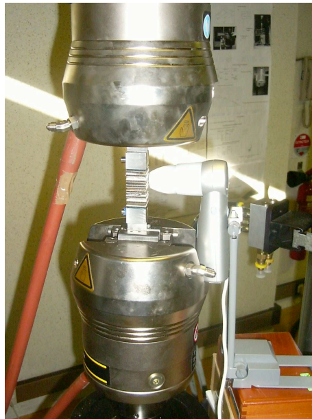
Figure III-7 – Système de capture d'images au cours de l'essai
