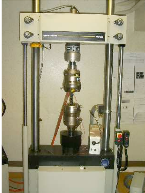
Figure III-2 –Machine pour les essais de traction à froid (ENSICA)
