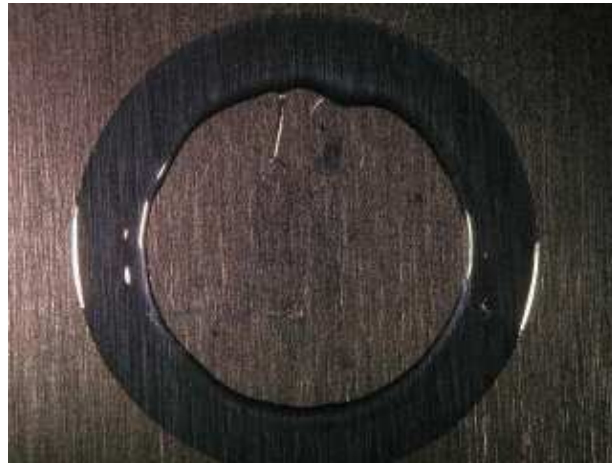
FIG. 7.13 – Photo d’un échantillon prise sur la plaque support juste après la rupture. L’expérience a été réalisée sur l’huile de silicones G20M, sur le pégosimètre Zwick pour une épaisseur h_0 = 200 \mu\text{m} et une vitesse de traction V = 0,15 \text{ mm/s} .
