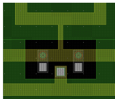
FIG. B.12. SQUID en boucle verticale WIR-GND. La ligne a une largeur ( W2 ) de 15 \mu\text{m} pour une longueur de 3xW2 .
