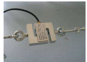
Jauge de contrainte, sensible à l'étirement créé entre ses 2 extrémités
