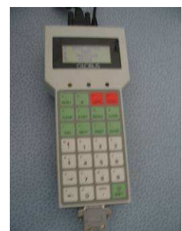
Boîtier ergométrique : réception du signal électrique provenant de la jauge, et transmission à l'ordinateur
