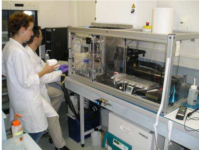
Figure 19 : Vue d'ensemble du Sciflexarrayer (éjecteur piézoélectrique).
