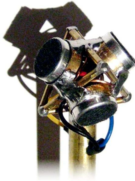
FIG. 1.5 : Un exemple de microphone soundfield pour la prise de son en format B. Ce modèle « artisanal » a été réalisé par Nick Mariette ([http://soundsorange.net/?projects:diy\\_ambisonic\\_microphone](http://soundsorange.net/?projects:diy_ambisonic_microphone)).
