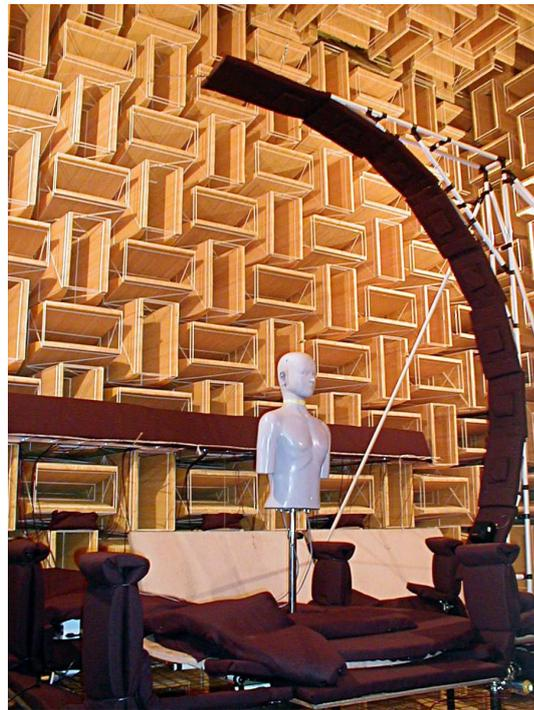
FIG. 1.2 : Mesure des HRTF d'un mannequin à l'université de Nagaoka (Japon). Des haut-parleurs sont disposés sur un arc de cercle dont la rotation permet l'enregistrement des HRTF pour un grand nombre de directions. Image issue de la page web [http://audio.nagaokaut.ac.jp/hrtf/index\\_e.html](http://audio.nagaokaut.ac.jp/hrtf/index_e.html)
