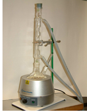
Figure 41 : Dispositif pour le dégazage de l'eau
