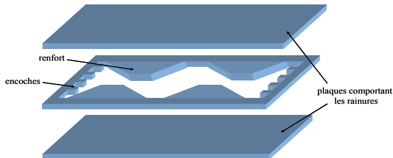
Figure 68 : La structure du caloduc 15M
