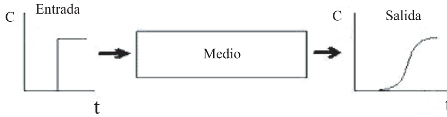
Figura 1.5: Dispersión hidrodinámica de un perfil de concentración en forma de escalón. Se observa la variación temporal cualitativa de la concentración en una posición a la entrada del medio (izq.) y otra a la salida (der.)
