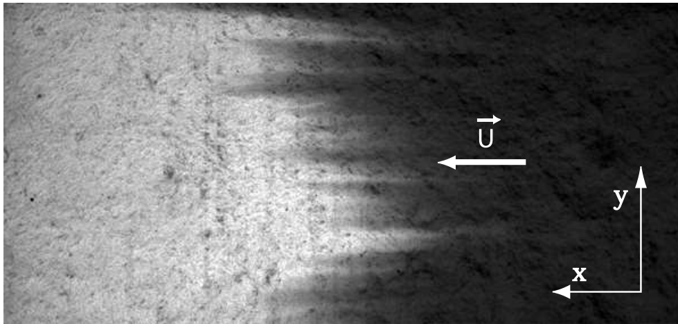
Figura 2.19: Imagen en niveles de gris tomada a la mitad del transcurso de una experiencia directa con solución polimérica de 500 ppm en las EFAF, caudal 1 ml/min. Se puede observar como el fluido coloreado (derecha) desplaza al fluido sin colorear.
