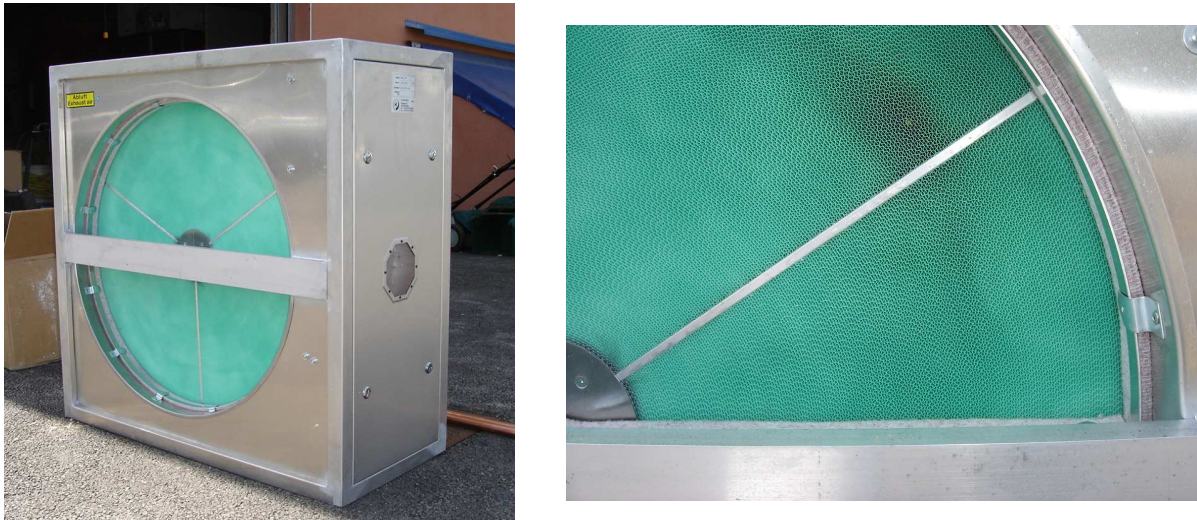
Figure 4.18: Vue de la roue dessiccante dans son caisson avant son installation dans la centrale.
