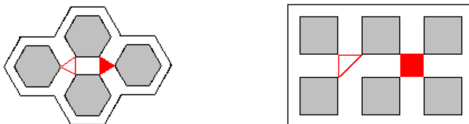
Figure 83 : Représentation des longueurs minimales entre points d'accroche du ménisque lors de la transition entre mailles et zone de discontinuité dans l'accrochage du ménisque
