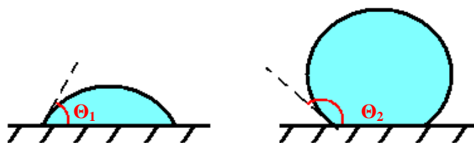
Figure 10 : Mouillage d'un fluide sur une paroi : à gauche, fluide mouillant et à droite fluide non mouillant
