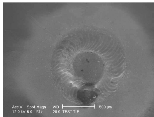
Figure 155 : Plaque avec bille refondue
