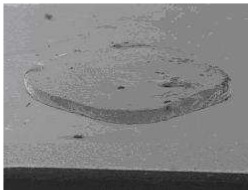
Figure 151 :Bille forcée dans un trou avant refusion périphérique
