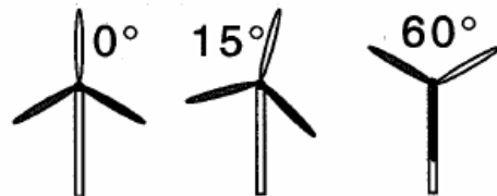
Figure 2-10 : Position du rotor pour 0°, 15° et 60° (la pale 1 est en blanc)
