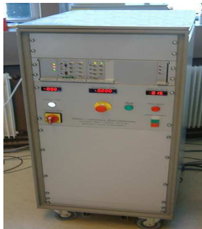
Figure 4-5 : Vue d'ensemble de la baie de puissance simulant le couple éolien
