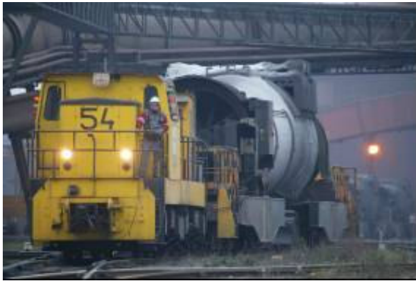
Figure 12 : Transport de la fonte liquide par wagons poche tonneaux
