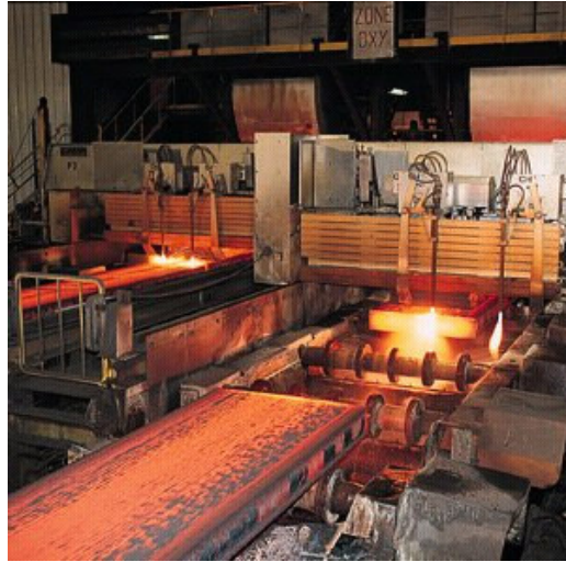
Figure 7 : D'acier liquide on obtient des brames* (ou blooms) qui sont des produits semi-finis.
