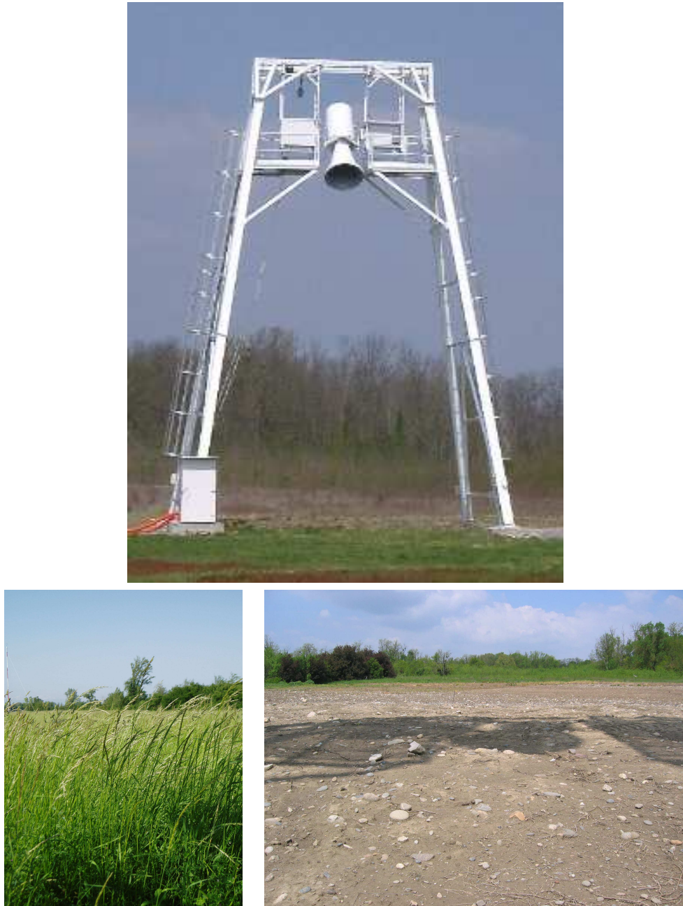
FIG. 3.8 – Radiomètre LEWIS et détail des surfaces observées.
