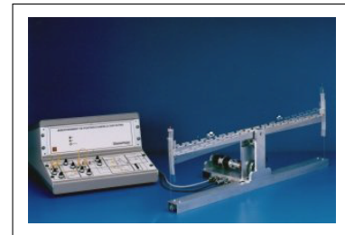
FIG. 3.14 – Plate-forme expérimentale de la bille sur le rail
