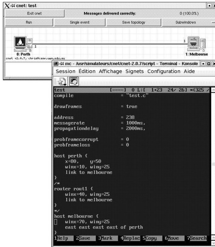
FIG. 2.2 – Topologie et fichier de configuration d'un réseau sous Cnet
