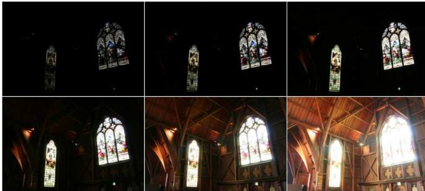
(a) Six prises de vue, avec différents temps d'intégration. Pour des images thermiques, il est impossible de choisir un temps d'intégration ne faisant saturer aucun point, tout en conservant assez de signal dans les autres zones de l'image.
