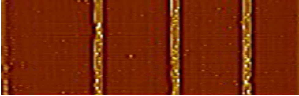
FIG. 5.10: Image AFM 11 \times 3,5 \mu\text{m}^2 d'un réseau de ligne de Nb. Ech. en z = 20 \text{ nm} ( \Delta f = 0,4 \text{ Hz} , T = 300 \text{ K} ). [Ech.47.c.γ].
