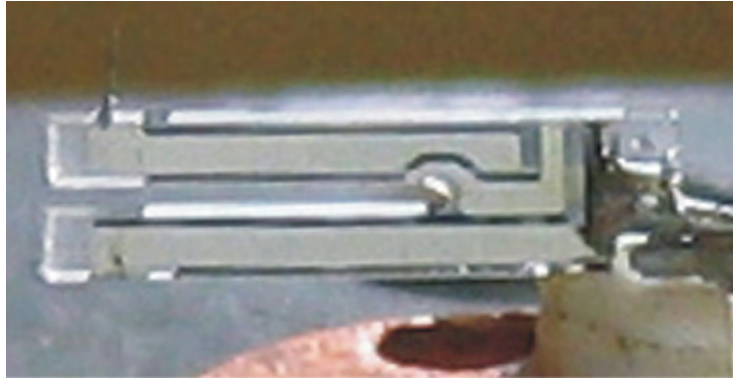
FIG. 2.11: Photographie d'une sonde AFM-STM basée sur un diapason.
