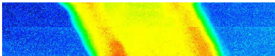
FIG. 4.6: Image AFM 700 \times 150\text{ nm}^2 d'une ligne de Nb. \Delta f = 0,4\text{ Hz} , T = 150\text{ mK} . [Ech.50. \gamma ].
