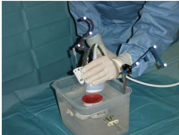
Figure 53 : Ponction du fantôme. On distingue l'aiguille à l'intérieur du fantôme. Le contrôle de la position de l'aiguille a été fait en s'assurant visuellement que la pointe de l'aiguille était bien au contact de la cible métallique.
