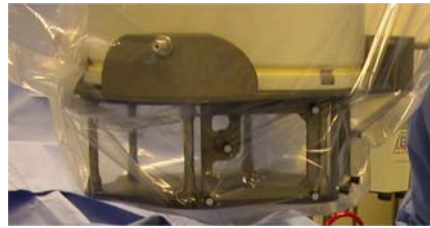
Figure 46 : Mire de calibration fixée sur le fluoroscope.
