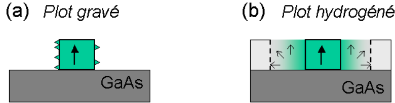
FIG. III.7 – Deux modes de nucléation préférentiels suivant la technique de structuration : (a) Nucléation sur une rugosité de bord pour les plots gravés. (b) Nucléation à l'interface douce magnétique pour les plots hydrogénés. Le front de diffusion de l'hydrogène est de l'ordre de 200 nm. A très faible densité de porteurs, loin du plot, l'aimantation bascule dans le plan.
