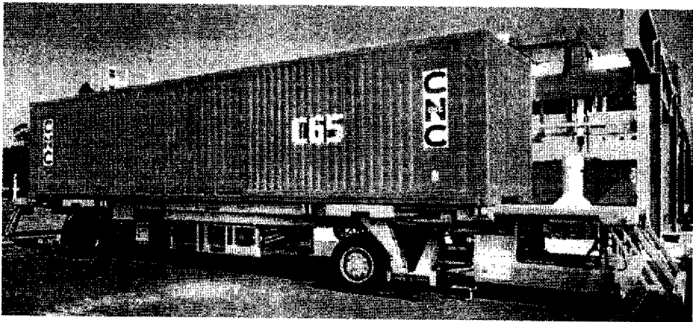
FIG. 22 - Le robot COMMUTOR de la SNCF sur lequel nous avons intégré une architecture de contrôle comprenant un superviseur, un planificateur de trajectoires, un module de surveillance... Une intégration similaire a également été réalisée sur un robot de l'aéroport de Francfort
