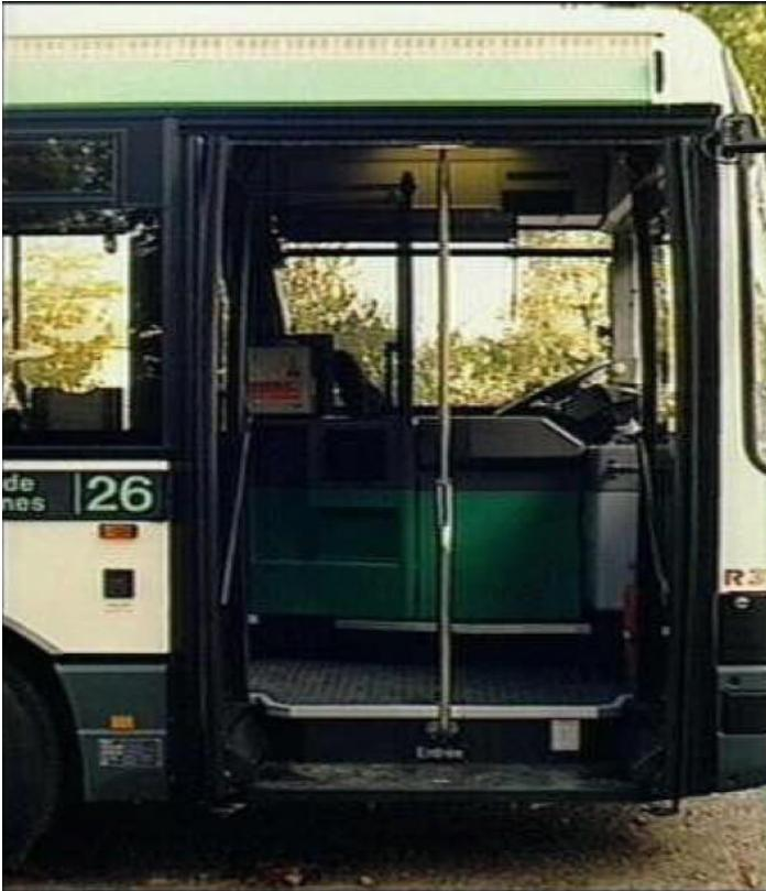
Photos montrant la présence de marches dans les bus R312 de Renault Véhicule Industriel. Photos Ratp, Gérard Dumax, n°182726 du 26/09/1988.
