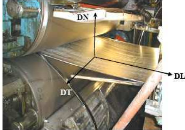
FIG. 1.4: Visualisation des axes DN (axe y de l'image), DL (axe x de l'image) et DT (axe z de l'image) pendant le laminage de la tôle.
