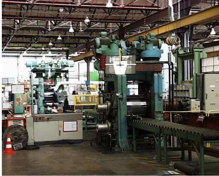
FIG. 1.3: Photographie du laminoir pilote de CRV ALCAN sur lequel les tôles AA5182 sont mises en forme.
