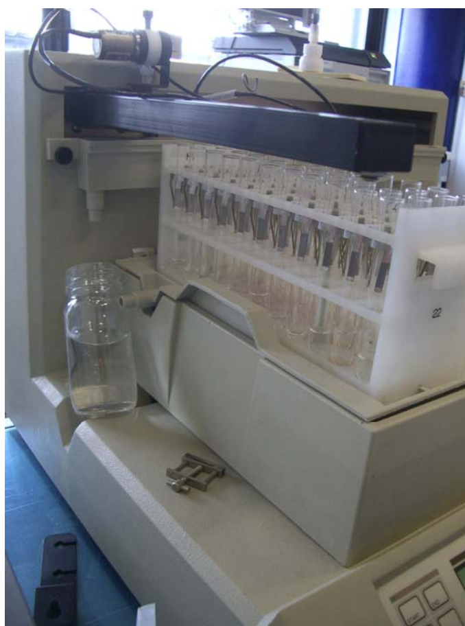
Figure 14 : Le collecteur de fraction permet d'isoler les constituants sélectionnés dans différents tubes à essais
