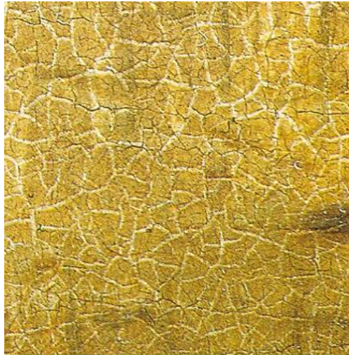
Figure 2 : exemple de craquelures « peau de crocodile » d'une couche de vernis ( photo [21] )
