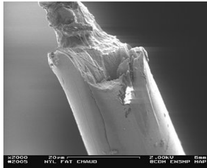
Figure 7-17 Faciès MEB de fissuration à chaud sur fibre de NYLON avec une pseudo languette et une zone complexe de multifissuration longitudinale à proximité.
