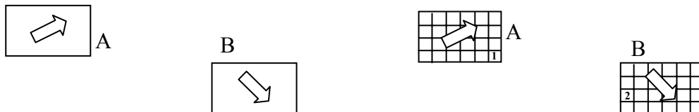
Fig. 3.10– Exemple de discrétisation de deux aimants A, B
